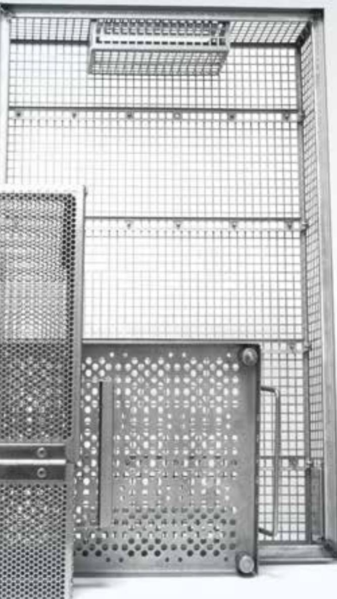
Les paniers peuvent être fabriqués de telle sorte qu'ils sont compatibles avec les systèmes existants et peuvent être utilisés en combinaison avec des paniers en fil métallique dans une usine. En matière d'ergonomie, des progrès considérables ont été réalisés en arrondissant tous les coins et poignées.
